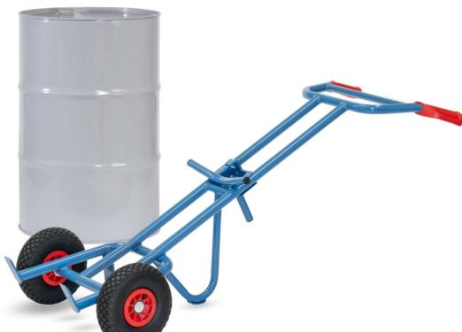
Fasskarre aus Stahlrohr geschweißt, pulverbeschichtet, blau RAL 5007, dauerhaft oberflächengeschützt. Räder mit Luftbereifung, Nabens mit Rollenlager. Für alle 200-Liter-Fässer mit Rand geeignet.
