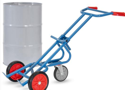
Fasskarre aus Stahlrohr geschweißt, pulverbeschichtet, blau RAL 5007, dauerhaft oberflächengeschützt. Räder mit Vollgummibereifung, Nabens mit Rollenlager. Für alle 200-Liter-Fässer mit Rand geeignet. Zusätzlich mit 1 Stütz-Lenkrolle TPE 200 x 40 mm.
