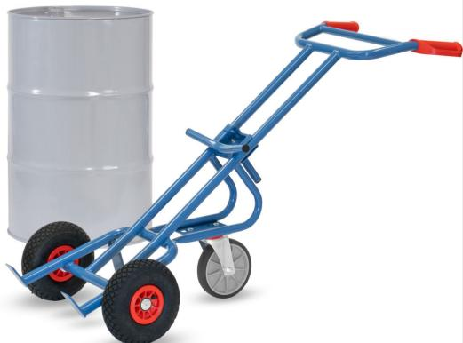
Fasskarre aus Stahlrohr geschweißt, pulverbeschichtet, blau RAL 5007, dauerhaft oberflächengeschützt. Räder mit Luftbereifung, Nabensicherung. Für alle 200-Liter-Fässer mit Rand geeignet. Zusätzlich mit 1 Stütz-Lenkrolle TPE 200 x 40 mm.
