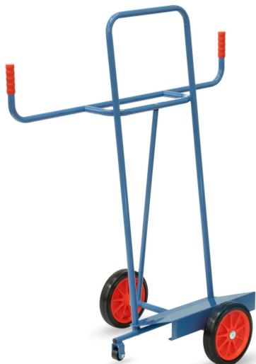
Stahlrohr-Konstruktion mit Stahlblechschaufel, pulverbeschichtet blau RAL 5007. Räder mit Vollgummi-Bereifung. Naben mit Rollenlager. 2 Stützrollen 50 mm Ø. Zum Längstransport von großflächigen Holz- und Kunststoffplatten. Zerlegte Anlieferung.
