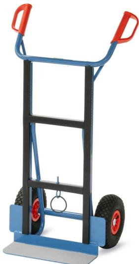
Geräteträger für Haushaltsgeräte. Geschweißte Stahlrohrkonstruktion, pulverbeschichtet blau RAL 5007. Zum Transport von Kühlschränken, Waschmaschinen, Öfen und weiteren Elektrogeräten. Eine breite Gummiauflage schützt die weiße Ware. Antirutschbelag auf der Schaufel. Lufträder 260 x 85 mm, Nabenhügel mit Rollenlagerung. Tragholt optional erhältlich.
