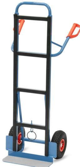
Geschweißte Stahlrohrkonstruktion, pulverbeschichtet blau RAL 5007. Zum Transport von Öfen, Kühlschränken, Waschautomaten u.ä. Breite Gummiauflage, Antirutschbelag auf der Schaufel. Lufträder 260 x 85 mm, Radnaben mit Rollenlager.
