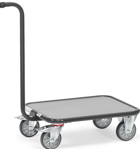
Griffroller in der Ausführung "GREY EDITION". Aus Stahlrohr geschweißt, pulverbeschichtet anthrazitgrau RAL 7016. Mit Holzplattform, Plattform mit im Rahmen liegender Holzwerkstoffplatte, Oberfläche mittelgrau. Griff anschraubar. 2 Lenk- und 2 Bockrollen, TPE-Bereifung (spurlos), Nabens mit Rillenkugellager, Feststeller an den Lenkrollen.
