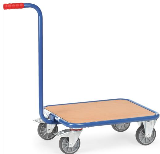
Griffroller aus Stahlrohr geschweißt, pulverbeschichtet brilliantblau RAL 5007. Mit Holzplattform, Plattform mit im Rahmen liegender Holzwerkstoffplatte, Oberfläche Buchendekor. Griff anschraubbar. 2 Lenk- und 2 Bockrollen, TPE-Bereifung (spurlos), Nabens mit Rillenkugellager, Feststeller an den Lenkrollen.
