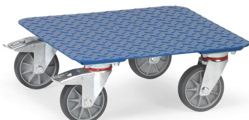
Schweißkonstruktion mit Stahl-Tränenblech-Plattform, pulverbeschichtet blau RAL 5007. 4 Lenkrollen, TPE-Bereifung, Nabens mit Rillenkugellager. 2 Stück mit Feststeller.
