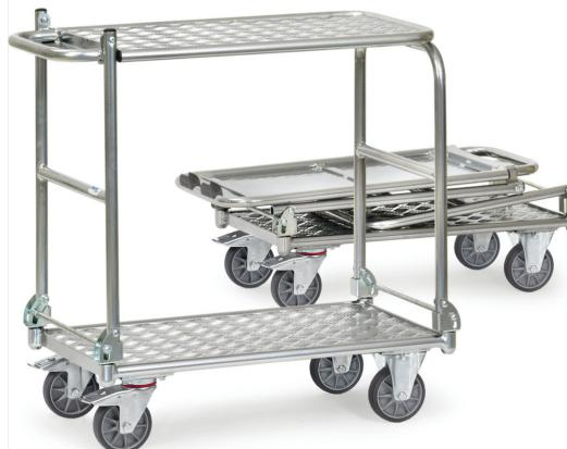
Klapptischwagen aus Alurohr mit Aluplatform. Sehr geringes Eigengewicht. Mit 2 klappbaren Bügeln und mit klappbarer Tischplattform ist der zusammen klappbare Tischwagen auch ideal für unterwegs. 2 Lenk- und 2 Bockrollen mit spurloser TPE-Bereifung und Nabenhüllen mit Rillenkugellager. Feststeller an den Lenkketten. Tragkraft obere Ladefläche 80 kg. Deutsches Patent 100 62 425.
