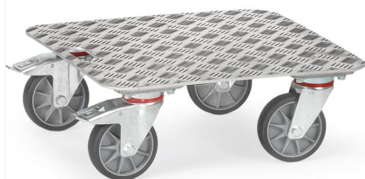
Schweißkonstruktion mit Aluminium-Quintettsblech-Plattform und Griffloch. 4 Lenkketten, TPE-Bereifung, Nabensicherung mit Rillenkugellager. 2 Stück mit Feststeller.
