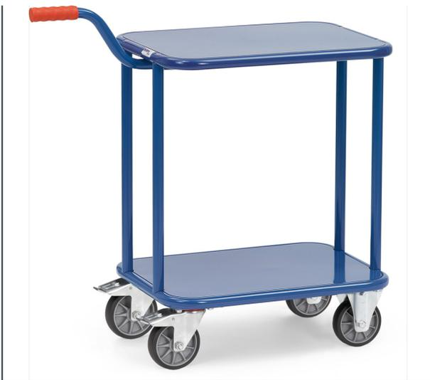
Aus Stahlrohr geschweißt mit Stahlblechplattform. 2 Plattformen mit bündig eingeschweißtem Stahlblech 2 mm stark, pulverbeschichtet brillantblau RAL 5007. Griff anschraubbar. 2 Lenk- und 2 Bockrollen, TPE-Bereifung (spurlos), Naben mit Rillenkugellager, Feststeller an den Lenkrollen. Tragkraft obere Ladefläche 100 kg.
