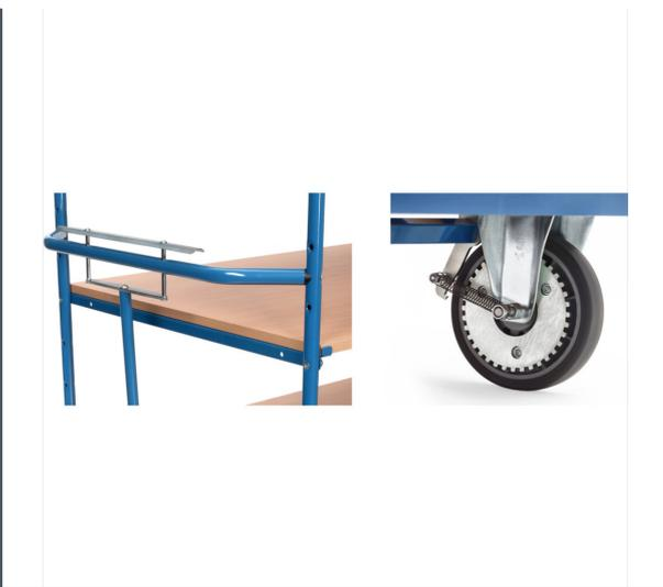
Kompakte und leichte Feststellbremse für alle Wagen mit 2 Bockrollen und serienmäßiger TPE-Bereifung bis 600 kg Tragkraft. Betätigungsleiste am Schiebegriff losgelassen = Bremse fest, Wagen ist zuverlässig gegen Wegrollen gesichert. Betätigungsleiste gedrückt = Bremse gelöst, Wagen lässt sich leicht verfahren. Ergonomische und leichtgängige Handhabung. Sichere Bremswirkung durch formschlüssige Sperrverzahnung. Nicht als Fahrbremse geeignet. Mehrpreis pro Wagen. Nicht nachrüstbar.
