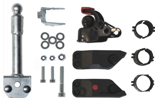
Anbausatz feuerverzinkt bestehend aus Kugelkupplung und Adapter für Sattelstützen von 26 bis 31 mm Durchmesser und Kugelschale mit Anschraubplatten an Standarddeichsel. Zuladung max. 40 kg, Aufliege last max. 4 kg. Nachrüstbar.
