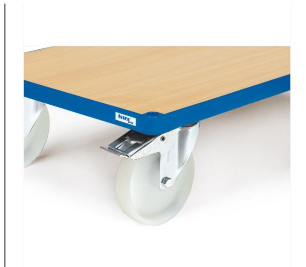
Mehrpreis für Räder mit Polyamid-Bereifung anstelle der Standard-Beräderung. Mehrpreis pro Wagen für Radgröße 150 x 40 mm. Nabens mit Rollenlager. Weitgehend beständig gegen Feuchtigkeit, Salz, Säuren und Laugen. Hitzebeständig von -40° bis +90°C.
