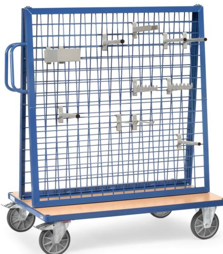
Profilstahl-Konstruktion mit eingeschweißtem Drahtgitter 75 x 75 mm, pulverbeschichtet blau RAL 5007. Boden durchgehend, Holzwerkstoffplatte, Oberfläche Buchendekor. Aufbauhöhe 1250 mm. Neigung der Gitter 11%. Beräderung: 2 Lenk- und 2 Bockrollen, TPE-Bereifung, Nabensicherung: Rillenkugellager. Feststeller an den Lenkrollen. Sinnvolles Zubehör für Werkstückwagen erhältlich (siehe Zubehör für Werkstattwagen).
