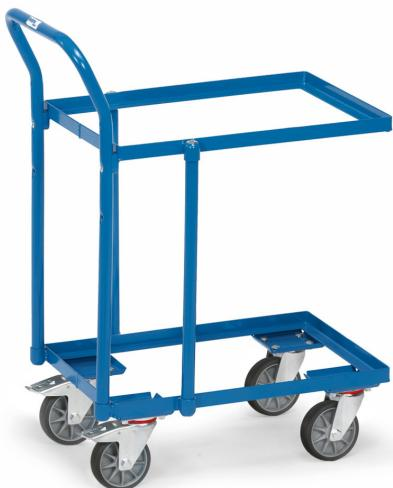
Etagen-Roller mit 2 Plattformen und Rohrschiebebügel, pulverbeschichtet blau RAL 5007. Zwei offene Rahmen zur Aufnahme von Eurokästen. Licher Etagenabstand 500 mm. Tragkraft obere Ladefläche 100 kg. 4 Lenkrollen mit TPE-Bereifung, Nabens mit Rillenkugellager. 2 Stück mit Feststeller. Passend für Eurokästen 600 x 400 mm. Zerlegte Anlieferung.
