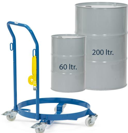
Fassroller für stehenden Transport von Stahlblechfässern mit 60 oder 200 Litern Inhalt. Verschweißte Stahlkonstruktion, pulverbeschichtet brilliantblau RAL 5007, Kreuzstreben nach unten durchgekröpft Ø 420 mm für 60-Liter-Fässer, Außenring Innen-Ø 610 mm für 200-Liter-Fässer. Mit anschraubbarem Rohrschiebebügel mit 2 Ösen und 1 Zurrkugel. 4 Lenkketten, 2 Stück mit Feststeller, Räder Polyamid, Nabenscheiben mit Gleitlagerung.
