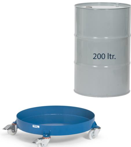
Fassroller für stehenden Transport von 200-Liter Stahlblechfässern. Verschweißte Stahlkonstruktion, pulverbeschichtet brilliantblau RAL 5007. Stahlblechwanne öldicht verschweißt. Innen-Ø 630 mm. Rand 80 mm hoch. 4 Lenkrollen, 2 Stück mit Feststeller, Räder Polyamid, Nabenhügel mit Gleitlagerung.
