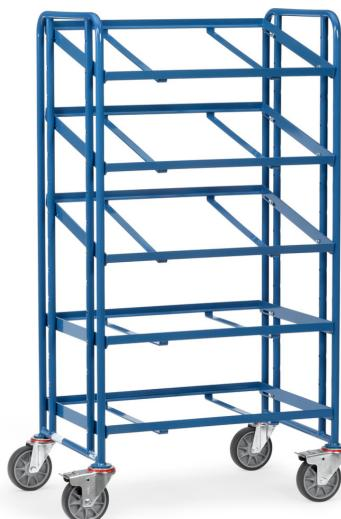
Eurokastenwagen im Baukasten-System: Stahlrohr und Profilstahl geschweißt, pulverbeschichtet blau RAL 5007, Schraubkonstruktion. Variabel einschraubbare Etagen, Raster 100 mm, Neigung bei schrägem Einbau 15° oder 30°. Tragkraft pro Ladefläche 80 kg. 5 Etagenrahmen passend für 10 Eurokästen 600 x 400 mm. 4 Lenkketten, TPE-Bereifung, Nabensicherung mit Rillenkugellager. 2 Stück mit Feststeller.
