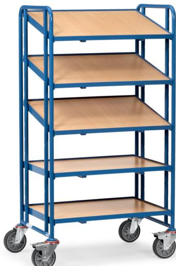
Eurokastenwagen im Baukasten-System: Stahlrohr und Profilstahl geschweißt, pulverbeschichtet blau RAL 5007, Schraubkonstruktion. Variabel einschraubbare Etagen im Raster von 100 mm, Neigung bei schrägem Einbau 15° oder 30°. Tragkraft pro Ladefläche 80 kg. 5 Etagenrahmen passend für 10 Eurokästen 600 x 400 mm. 4 Lenkrollen, TPE-Bereifung, Nabenhügel mit Rillenkugellager. 2 Stück mit Feststeller.
