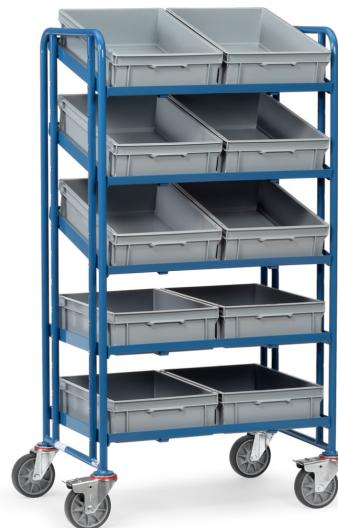
Eurokastenwagen im Baukasten-System: Stahlrohr und Profilstahl geschweißt, pulverbeschichtet blau RAL 5007, Schraubkonstruktion. Variabel einschraubbare Etagen, Raster 100 mm, Neigung bei schrägem Einbau 15° oder 30°. Tragkraft pro Ladefläche 80 kg. 5 offene Etagenrahmen mit 10 Eurokästen 600 x 400 x 145 mm. 4 Lenkrollen, TPE-Bereifung, Nabensicherung mit Rillenkugellager. 2 Stück mit Feststeller.
