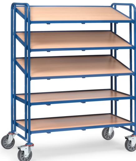
Eurokastenwagen im Baukasten-System: Stahlrohr und Profilstahl geschweißt, pulverbeschichtet blau RAL 5007, Schraubkonstruktion. Variabel einschraubbare Etagen im Raster von 100 mm möglich. Neigung bei schrägem Einbau 15° oder 30°. Tragkraft pro Ladefläche 80 kg. 5 Etagenrahmen passend für je 3 Eurokästen 600x400 mm. 4 Lenkketten mit TPE-Bereifung und Nabenhügel mit Rillenkugellager. 2 Stück mit Feststeller.
