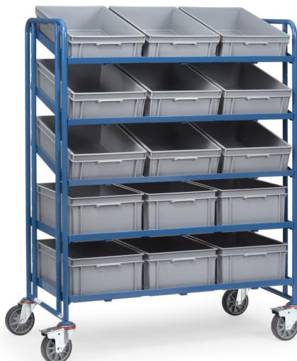
Eurokastenwagen im Baukasten-System: Stahlrohr und Profilstahl geschweißt, pulverbeschichtet blau RAL 5007, Schraubkonstruktion. Variabel einschraubbare Etagen, Raster 100 mm, Neigung bei schrägem Einbau 15° oder 30°. Tragkraft pro Ladefläche 80 kg. 5 Etagenrahmen mit 3 Eurokästen 600 x 400 x 145 mm, 6 Eurokästen 600 x 400 x 170 mm und 6 Eurokästen 600 x 400 x 220 mm. 4 Lenkrollen, TPE-Bereifung, Nabens mit Rillenkugellager. 2 Stück mit Feststeller.
