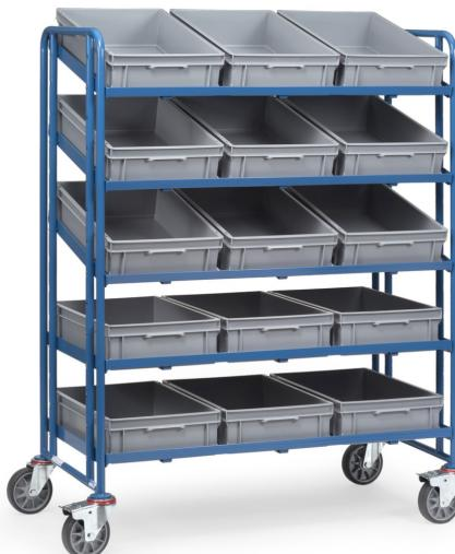
Eurokastenwagen im Baukasten-System: Stahlrohr und Profilstahl geschweißt, pulverbeschichtet blau RAL 5007, Schraubkonstruktion. Variabel einschraubbare Etagen, Raster 100 mm, Neigung bei schrägem Einbau 15° oder 30°. Tragkraft pro Ladefläche 80 kg. 5 Etagenrahmen mit 15 Eurokästen 600 x 400 x 145 mm. 4 Lenkrollen, TPE-Bereifung, Naben mit Rillenkugellager. 2 Stück mit Feststeller.
