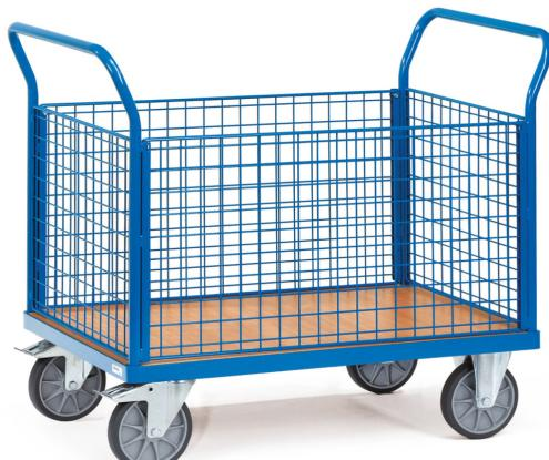
Vierwandwagen aus Stahlrohr und Profilstahl geschweißt, pulverbeschichtet blau RAL 5007. Plattform Holzwerkstoffplatte, Oberfläche Buchendekor. 2 Stirnwände und 2 Längswände aus Drahtgitter 50 x 50 x 4 mm, Wände 500 mm hoch. Eine Längswand zum leichteren be- und entladen herausnehmbar. 2 Lenk- und 2 Bockrollen mit TPE-Bereifung, Nabensicherung mit Rillenkugellager. Feststeller an den Lenkrollen.
