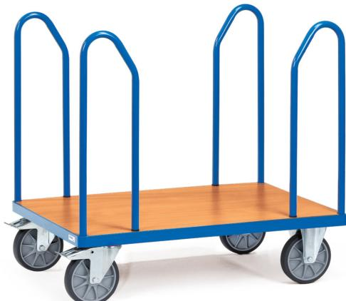
Seitenbügelwagen aus Stahlrohr und Profilstahl geschweißt, pulverbeschichtet brilliantblau RAL 5007, Plattform Holzwerkstoffplatte, Oberfläche Buchendekor. Mit 4 Bügeln. Bügelhöhe 720 mm. 2 Lenk- und 2 Bockrollen, TPE-Bereifung, Nabensicherung mit Rillenkugellager. Feststeller an den Lenkketten.
