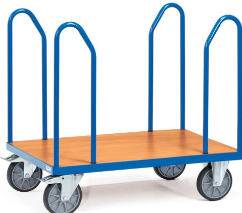
Seitenbügelwagen aus Stahlrohr und Profilstahl geschweißt, pulverbeschichtet brilliantblau RAL 5007, Plattform Holzwerkstoffplatte, Oberfläche Buchendekor. Mit 4 Bügeln. Bügelhöhe 720 mm. 2 Lenk- und 2 Bockrollen, TPE-Bereifung, Nabenhügel mit Rillenkugellager. Feststeller an den Lenkketten.
