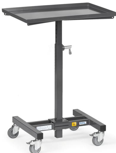
Elektrisch leitfähige Ausführung. Für Kunststoffkästen, Stahlblechkästen, Drahtkörbe, usw., höhenverstellbar und fahrbar. Profilstahl-/Rohrkonstruktion mit Stahlblechplattform mit allseitigem Rand 20 mm hoch. Nicht neigbar. Höhenverstellbar im Raster von 25 mm. Pulverbeschichtet, schiefergrau RAL 7015. 4 Lenkketten mit TPE-ESD-Bereifung, Nabensicherung. Feststeller an 2 Lenkketten.
