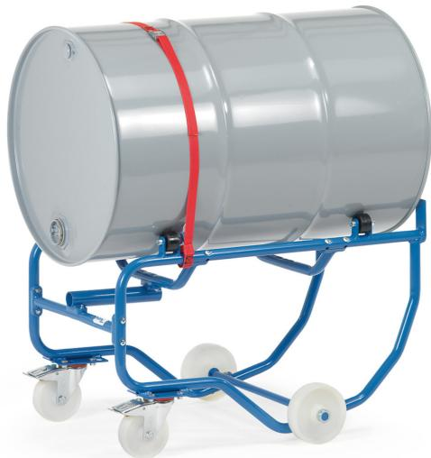
Zum Lagern und Entleeren von 200-Liter-Stahlfässern. Stahlrohr-Konstruktion, verschraubt, pulverbeschichtet blau RAL 5007. Spanngurt zur Fass-Sicherung. Vollwertiger Fasskipper mit Hebelstange, fahrbar. Mit Rollen zum Verdrehen der Fässer. Aufnahme der Fässer ohne Hebegerät mittels Kippvorgang mit Hebelstange. 2 Lenkketten mit Rädern 125 x 38 mm und 2 Räder 150 x 42 mm. Feststeller an den Lenkketten Außenmaße LxBxH: 900 x 615 x 600 mm.
