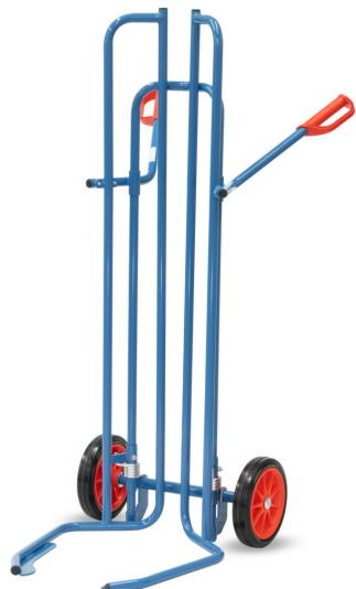
Reifenkarre aus Stahlrohr geschweißt, pulverbeschichtet blau RAL 5007, dauerhaft oberflächengeschützt. Räder mit Vollgummibereifung. Nabens mit Rollenlager. Mittels durch die Griffholme zu bedienende Spreiz-Aufnahmen können Reifenstapel direkt aufgenommen oder abgesetzt werden. Geeignet für Reifen von 450 bis 750 mm Ø. Bis zu 8 Reifen oder Räder möglich. Kompatibel mit "TYRE TROLLEY" 4546 und 4547.
