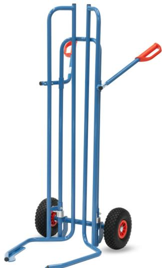
Reifenkarre aus Stahlrohr geschweißt, pulverbeschichtet blau RAL 5007, dauerhaft oberflächengeschützt. Räder mit Luftbereifung. Nabens mit Rollenlager. Mittels durch die Griffholme zu bedienende Spreiz-Aufnahmen können Reifenstapel direkt aufgenommen oder abgesetzt werden. Geeignet für Reifen von 450 bis 750 mm Ø. Bis zu 8 Reifen oder Räder möglich.
