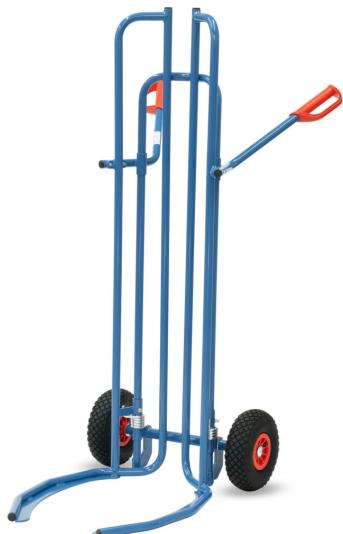
Reifenkarre aus Stahlrohr geschweißt, pulverbeschichtet blau RAL 5007, dauerhaft oberflächengeschützt. Räder mit Vollgummibereifung. Nabens mit Rollenlager. Mittels durch die Griffholme zu bedienende Spreiz-Aufnahmen können Reifenstapel direkt aufgenommen oder abgesetzt werden. Geeignet auch für größere Reifen wie z.B. SUVs von 450 bis 860 mm Ø. Bis zu 8 Reifen oder Räder möglich.
