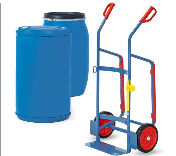
Fasskarre für den Transport von Kunststoff-Fässern mit 120-220 Liter Inhalt. Stahlrohr geschweißt, pulverbeschichtet, blau RAL 5007, dauerhaft oberflächengeschützt. Räder mit Vollgummibereifung, Nabens mit Rollenlager. Spanngurt zur Fass-Sicherung.
