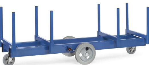
Profilstahl-Konstruktion mit einsteckbaren Stahlrohr-Rungen, 2 Materialmulden, pulverbeschichtet, blau RAL 5007. Mitte frei für Kran- oder Stapler-Beladung. Beräderung: Mittelradsatz, an den Stirnseiten je 1 Lenkrolle, Feststeller am Mittelradsatz. Gesamtbreite 700 mm, lichte Breite 600 mm.
