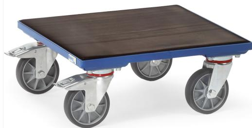
Aus Winkelstahl, geschweißt, pulverbeschichtet blau RAL 5007. Mit Holzplattform mit Riefengummi bespannt, 4 Lenkketten, TPE-Bereifung, Nabensicherung mit Rillenkugellager. 2 Stück mit Feststeller.
