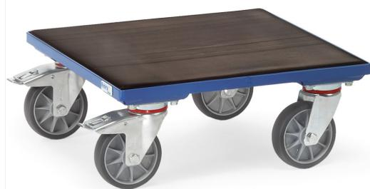
Aus Winkelstahl, geschweißt, pulverbeschichtet blau RAL 5007. Mit Holzplattform mit Riefengummi bespannt, 4 Lenkketten, TPE-Bereifung, Nabensicherung mit Rillenkugellager. 2 Stück mit Feststeller.
