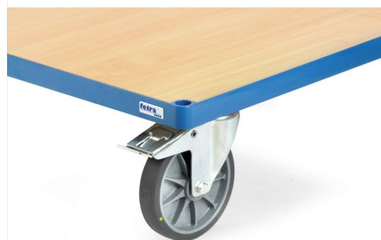
Mehrpreis für elektrisch leitfähige (antistatisch) TPE-ESD-Räder anstelle der Standard-Beräderung. Mehrpreis pro Wagen für Radgröße 125 x 32 mm. Nabens mit Präzisions-Rillenkugellager. Nicht kreidend (spurlos).
