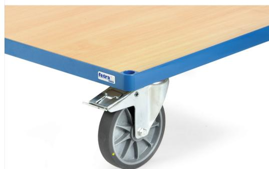
Mehrpreis für elektrisch leitfähige (antistatisch) TPE-ESD-Räder anstelle der Standard-Beräderung. Mehrpreis pro Wagen für Radgröße 200 x 40 mm. Nabens mit Präzisions-Rillenkugellager. Nicht kreidend (spurlos).
