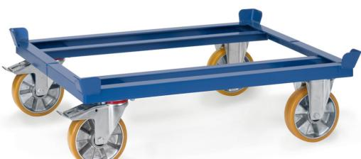
Für Flachpaletten und Gitterboxen. Robuste Winkelstahl-Schweißkonstruktion, mit 4 Fangecken, pulverbeschichtet, blau RAL 5007. 2 Lenk- und 2 Bockrollen, Polyurethan-Bereifung, Nabensicherung, Feststeller an den Lenkkästen. Geringer Rollwiderstand, elastischer Lauf, keine Fahrgeräusche.
