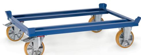
Für Flachpaletten und Gitterboxen. Robuste Winkelstahl-Schweißkonstruktion, mit 4 Fangecken, pulverbeschichtet, blau RAL 5007. 2 Lenk- und 2 Bockrollen, Polyurethan-Bereifung, Nabensicherung, Feststeller an den Lenkkästen. Geringer Rollwiderstand, elastischer Lauf, keine Fahrgeräusche.
