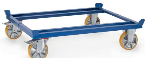
Für Flachpaletten und Gitterboxen. Robuste Winkelstahl-Schweißkonstruktion, mit 4 Fangecken, pulverbeschichtet, blau RAL 5007. 2 Lenk- und 2 Bockrollen, Polyurethan-Bereifung, Nabens mit Kugellager, Feststeller an den Lenkketten. Geringer Rollwiderstand, elastischer Lauf, keine Fahrgeräusche.
