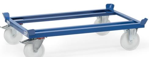
Für Flachpaletten und Gitterboxen. Robuste Winkelstahl-Schweißkonstruktion, mit 4 Fangecken, pulverbeschichtet, blau RAL 5007. 2 Lenk- und 2 Bockrollen, Polyamid-Räder, Nabens mit Rollenlager, Feststeller an den Lenkrollen. Geringer Rollwiderstand, hohe chemische Beständigkeit, nicht kreidend = spurlos. Fahrgeräusche.
