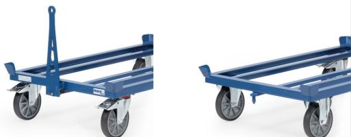
Deichsel und Kupplungszapfen für Paletten-Fahrgestelle. Für den Transport mit Zugfahrzeugen bis 6 km/h. Züge bis 5 Fahrgestelle möglich. Maximales Zuggewicht 2.000 kg. Deichsel aus Flachstahl, stellt sich mittels Gasdruckfedern selbsttätig in senkrechte Ruheposition. An der Bockrollenseite befindet sich ein stabiler profilierter Kupplungsbolzen. Verbindung durch Fußbetätigung möglich.
