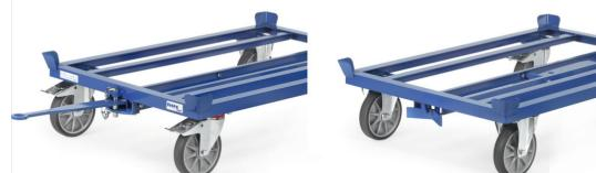
Deichsel und Kupplung für Paletten-Fahrgestell. Für den Transport mit Zugfahrzeugen bis 6 km/h. Züge bis 5 Fahrgestelle möglich. Maximales Zuggewicht 2.000 kg. Deichsel aus Flachstahl, im Ruhezustand unter den Rahmen einschiebbar. An der Bockrollenseite befindet sich ein stabiler abgekanteter Kupplungsbolzen. Verbindung durch Fußbetätigung möglich. Deutsches Patent: 10 2004 061 440.
