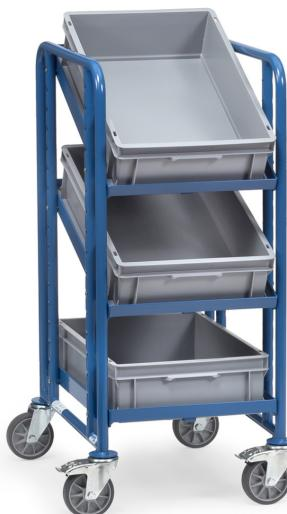
Stahlrohr und Profilstahl-Konstruktion, pulverbeschichtet RAL 5007. Schraubkonstruktion. Offene Etagenrahmen variabel einschraubar, Raster 50 mm, Neigung bei schrägem Einbau 15° oder 30°. Tragkraft obere und mittlere Ladefläche 80 kg. Mit 3 Eurokästen 600 x 400 x 145 mm. 4 Lenkketten, TPE-Bereifung, Nabensicherung mit Rillenkugellager. 2 Stück mit Feststeller.
