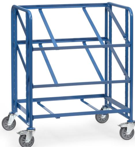
Stahlrohr und Profilstahl-Konstruktion, pulverbeschichtet RAL 5007. Schraubkonstruktion. Etagenrahmen variabel einschraubar, Raster 50 mm, Neigung bei schrägem Einbau 15° oder 30°. Tragkraft obere und mittlere Ladefläche 80 kg. 3 Etagenrahmen passend für je 1 Eurokasten. 4 Lenkketten, TPE-Bereifung, Nabensicherung mit Rillenkugellager. 2 Stück mit Feststeller.
