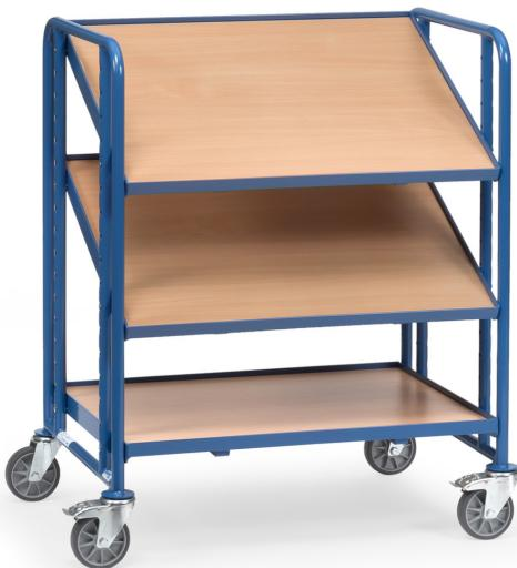
Stahlrohr und Profilstahl-Konstruktion, pulverbeschichtet RAL 5007. Schraubkonstruktion. Etagenrahmen mit Holzwerkstoffplatte, Oberfläche Buchendekor. Variabel einschraubar, Raster 50 mm, Neigung bei schrägem Einbau 15° oder 30°. Tragkraft obere und mittlere Ladefläche 80 kg. 3 Holzwerkstoffplatten, Rand 13 mm hoch. 4 Lenkrollen, TPE-Bereifung, Nabenhügel mit Rillenkugellager. 2 Stück mit Feststeller.
