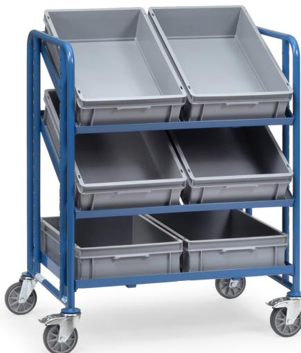
Stahlrohr und Profilstahl-Konstruktion, pulverbeschichtet RAL 5007. Schraubkonstruktion. Offene Etagenrahmen variabel einschraubar, Raster 50 mm, Neigung bei schrägem Einbau 15° oder 30°. Tragkraft obere und mittlere Ladefläche 80 kg. Mit 6 Eurokästen 600 x 400 x 145 mm. 4 Lenkketten, TPE-Bereifung, Nabensicherung. 2 Stück mit Feststeller.
