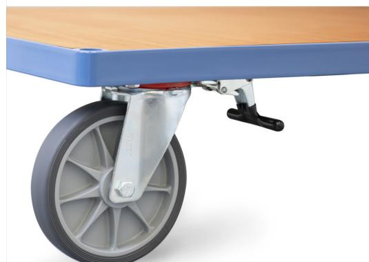
Mehrpreis für Ausstattung mit Richtungsfeststeller. Anstelle der 2 Bockrollen werden 2 Lenkrollen mit Richtungsfeststeller (4x 90° Arretierung) montiert. Dadurch wird ein guter Geradeauslauf in Längs- und Querrichtung möglich. Der feststehende Bedienhebel ist in jeder Rollenposition von der Längsseite aus zu bedienen. Mehrpreis pro Wagen. NUR auf Standard TPE-Bereifung.
